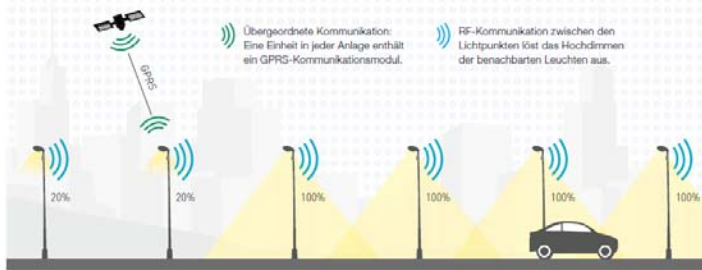
Bild 1: Der Radar erfasst die sich nähernden Fahrzeuge (bis zu einer Geschwindigkeit von 200 km/h) und kommuniziert den benachbarten Leuchten, die Lichtintensität zu erhöhen. Die Anzahl der aktivierten Leuchten und die Dauer der Aktivierung sind einstellbar.
