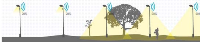
Bild 2: Der Radar erfasst die sich nähernden Fussgänger (ab einer Geschwindigkeit von 2 km/h) und kommuniziert den benachbarten Leuchten, die Lichtintensität zu erhöhen. Die Anzahl der aktivierten Leuchten und die Dauer der Aktivierung sind einstellbar.
